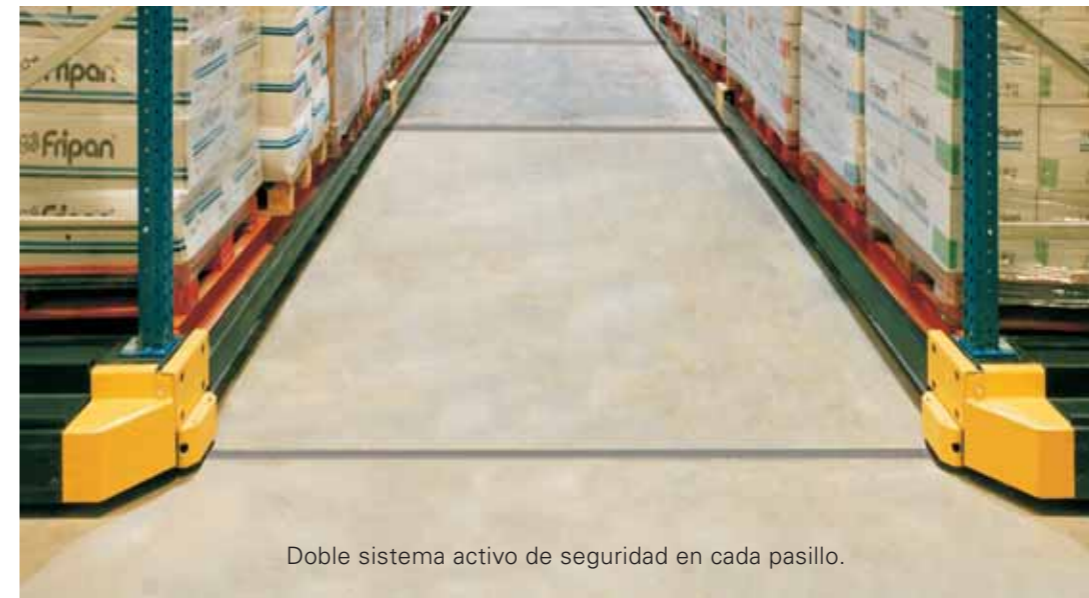
Célula frontal, para mayor seguridad del personal, protección del equipo utilizado y de las bases móviles.
